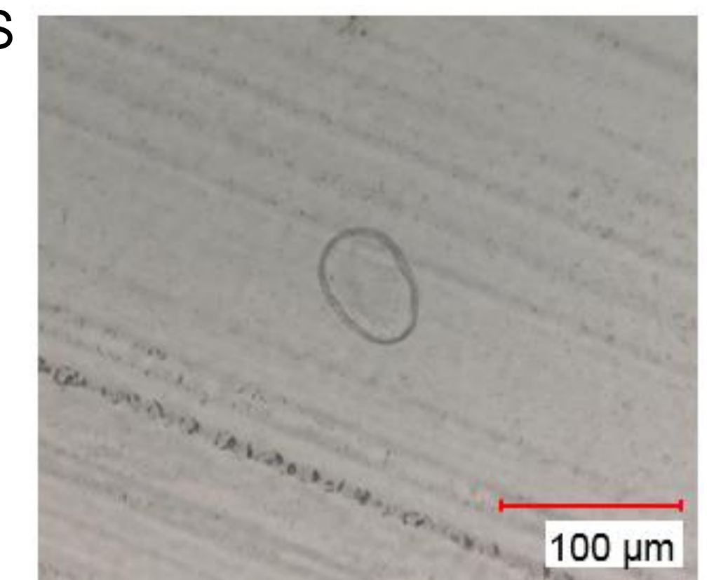
Abb. 5: Mikroskopische Aufnahme des Rückstands der 6-fach Dosierung einer 1000 \mu\text{g/mL} Sr-Lösung (234 pg) auf Technovit 7100.
